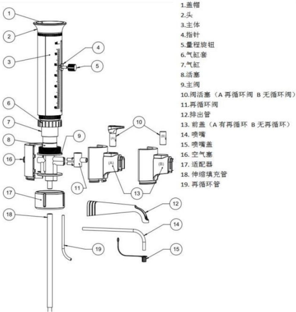
注意：再循环管只能用于带有再循环管阀结构的分液器中
