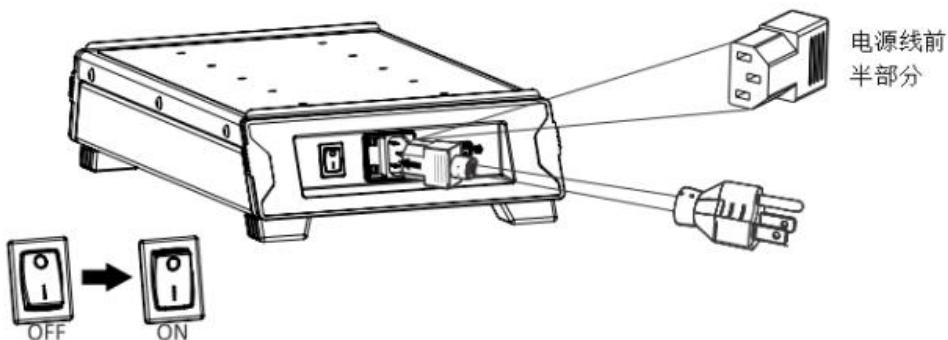
连接好电源线后，打开电源并从背面如上图所示。
