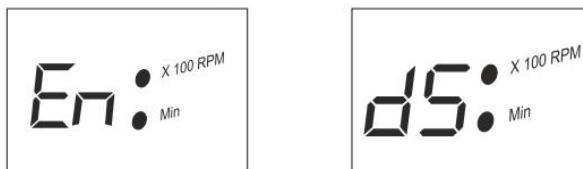
如上图所示，用户长时间按定时器按钮可以开启和关闭不平衡检测功能，显示器将显示“En”或“dS”状态
