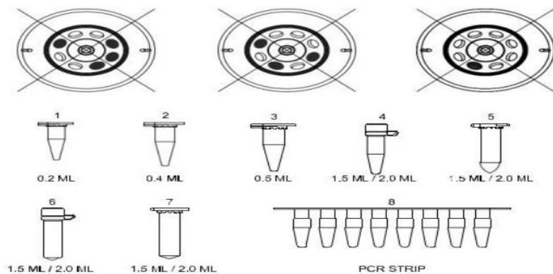
8 种不同类型的试管可以用两个可互换的转子离心
