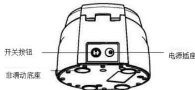
个人微型离心机提供独立的包装盒，打开包装盒子，然后轻取出离心机，在连接到主电源前插入电源适配器；说明书及附件应同离心机一起保存，请将所有包装保存至少2年，以供保修之用；确保转子足够紧，以避免出现任何事故，用微管加载转子进行离心，打开后部的开关，设定所需的速度和时间并关闭盖子开始离心。
