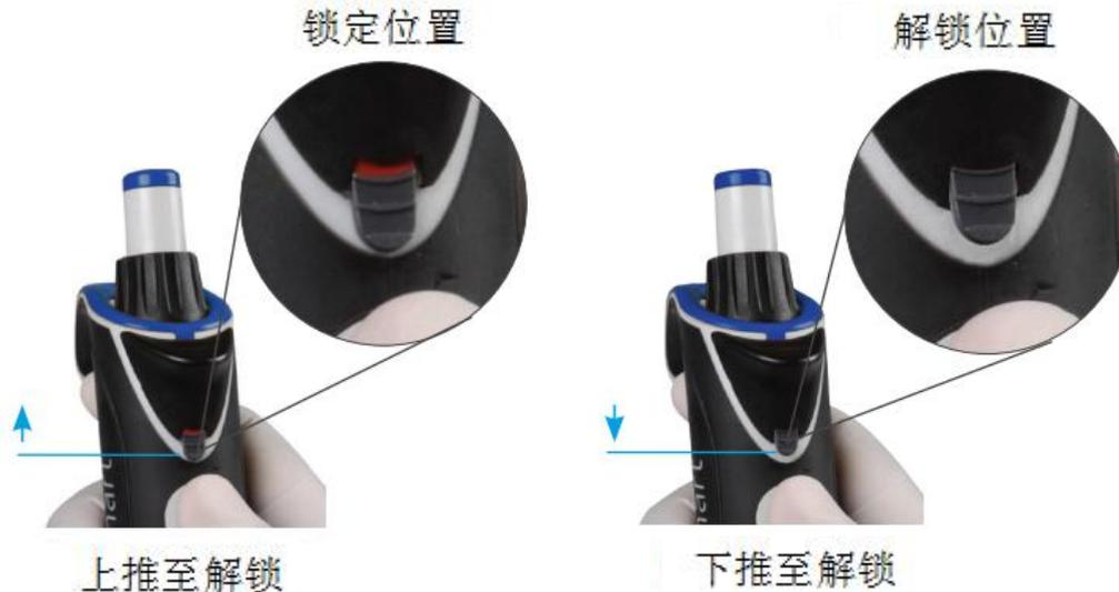
解锁计数器后，您可以使用移液器上侧的量程调节旋钮设置移液体积。要减小移液量，请顺时针转动，增大移液量，逆时针转动；务必确保所需的移液量与指针对齐，向下拉锁，确保在移液过程中不会使量程改变。
