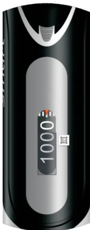
器的最后一个转轮上有一个刻度，用来帮助精确设定移液体积。
