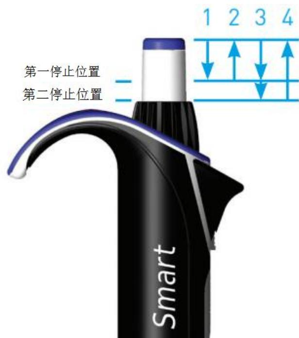
大约一秒钟的延迟，继续将操作手柄一直接到第二个停止位置，此操作将清空尖端液体残留
