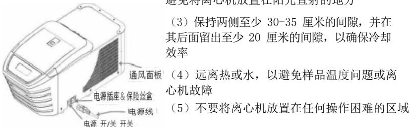
将电源适配器的一侧连接到离心机的后侧，另一侧连接至电源，如下图所示
