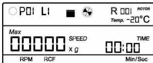
如上图所示，“P01L1”左边的圆圈 0 是空白的，表示在特定程序的任何一行中没有值。一旦任何程序行被填充或设置，将出现以下显示变化，在“P01L3”
